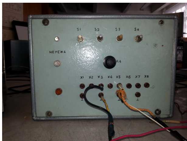
Рисунок 14 – Макет для досліджень диференційного підсилювач
